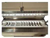
• **温区结构**:注:需求长尺寸恒温区可参照(不含隔温板尺寸) 需求温区温差梯度的参照(含隔温板尺寸)
